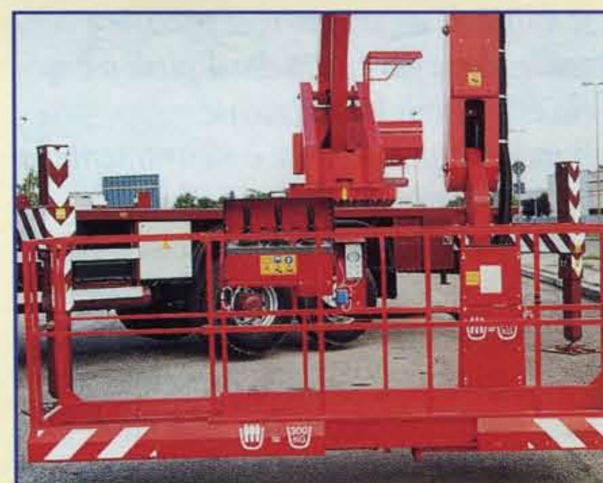
SOPRA: quadro comando del cestello SOTTO: cestello estensibile in alluminio con possibilità di rotazione 90°+90°
