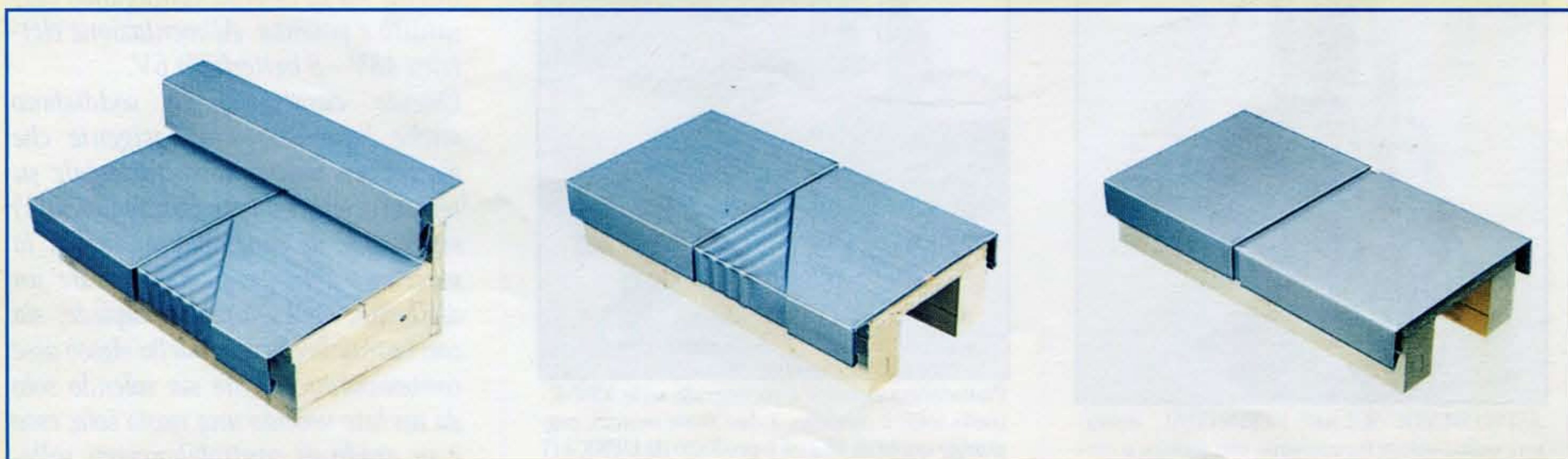
Esempio di nuovo giunto (visto in sezione) per copertine e scossaline ottenuto mediante Ondulina sottogiunto Rheinzink®
